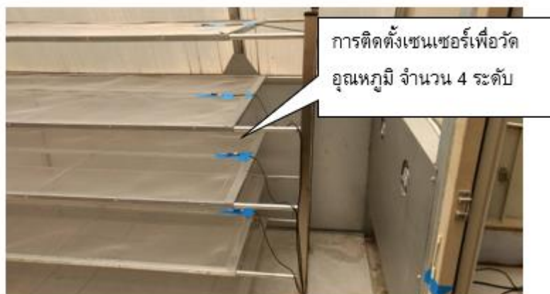
รูปที่ 6 ตำแหน่งการติดตั้งเซนเซอร์อ่านค่าอุณหภูมิ
