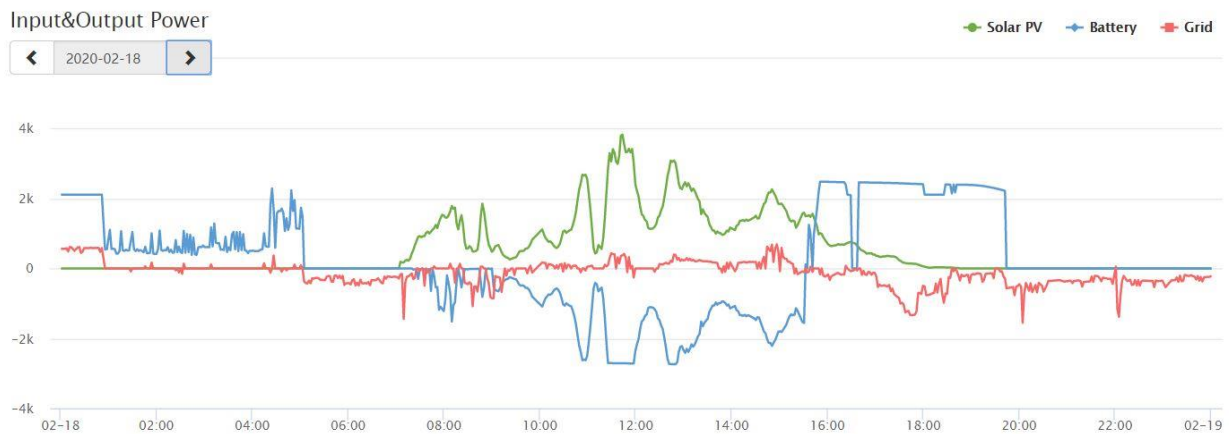
รูปที่ 8 การตอบสนองของระบบเมื่อพลังงานแสงอาทิตย์ลดระดับลงเมื่อมีฝนตก ตัวอย่างข้อมูลที่ 3
