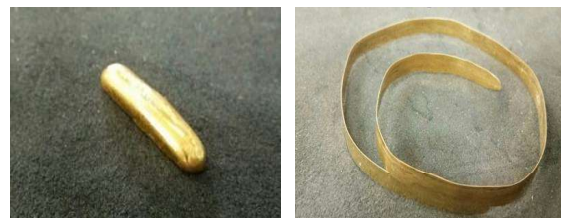
รูปที่ 2 โลหะประสานทองคำ 965 หลังการหล่อขึ้นรูปและรีดเป็นแผ่น
