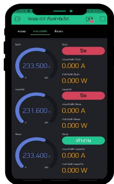
รูปที่ 10 การทดสอบการสั่งงานให้พัดลมทำงานผ่านแอปพลิเคชัน
