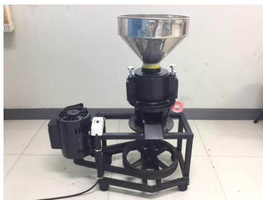
รูปที่ 7 เครื่องอัดขนาดห้องปฏิบัติการ (Lab scale)
