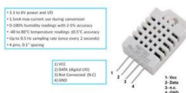
รูปที่ 1 DHT22 Temperature-Humidity Sensor
