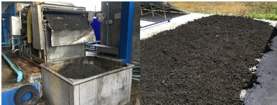
รูปที่ 6 กากตะกอนน้ำเสียที่ถูกรีดน้ำจากเครื่องรีด (Filter Press)
