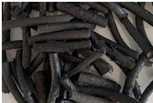
รูปที่ 11 การขึ้นรูปเม็ดเชื้อเพลิงจากกากตะกอนน้ำเสีย
