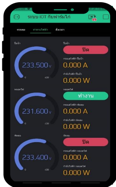
รูปที่ 9 การทดลองสั่งงานให้หลอดไฟฟ้าทำงานผ่านแอปพลิเคชัน
