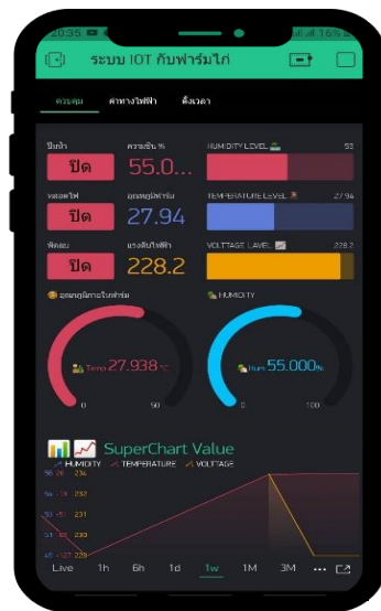
รูปที่ 11 การแสดงเกจค่าอุณหภูมิและค่าความชื้นบนแอปพลิเคชัน
